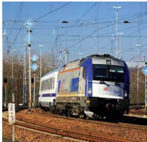
Der Berlin-Warszawa-Express an der Schnittstelle der Stromsysteme im Bahnhof Frankfurt (Oder) Oderbrücke
